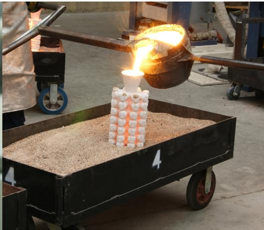
Fundición y vertidos en los moldes cerámicos, previamente sinterizados y pre-calentados.
