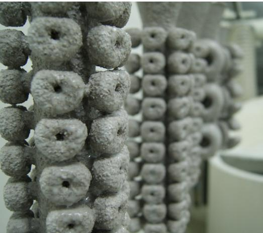
Recubrimiento de los árboles en cera con diferentes capas de lodos y arenas cerámicas para la fabricación de los moldes.
